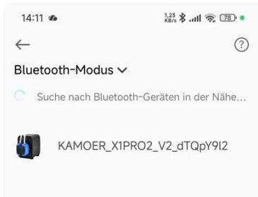
Im Bluetooth Modus findet die App nun automatisch die Dosierpumpe. Durch den in der App integrierten QR Code Scanner muss der Code auf der Unterseite der Pumpe nun gescannt werden. Die App findet die Pumpe und Sie ist nun bereit, um benutzt zu werden.
